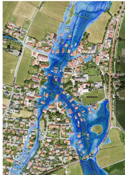
Gefährdungslage bei einem HQ 100 – mit Dammbbruchszenario
